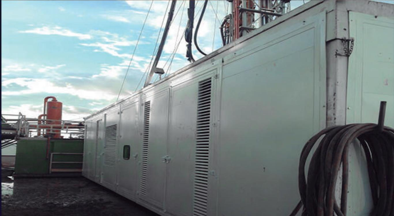
Los elementos de insonorización para equipos de perforación son diseñados a medida **buscado mantener la operabilidad de las maquinas.**
